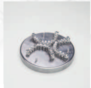
3 Bridges en CrCo fabriqués en 3h20
