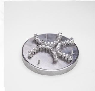
3 Abutments aus CoCr, gedruckt in 3Std20
